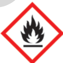
9422 A B C D E G GHS02 - Materiali infiammabili
